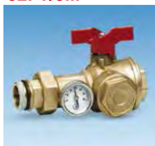
Valvola a sfera F x bocchettone, con filtro incorporato tipo FM 28 ispezionabile. Con predisposizione termometro Art. T40/60 (non incluso). Maniglia farfalla rossa.
