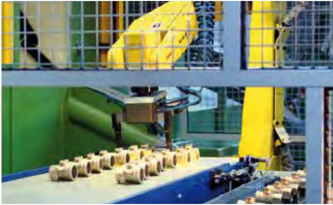
Dettaglio di caricamento robotizzato su macchina transfer. A detail of robotised loading on a transfer machine.
